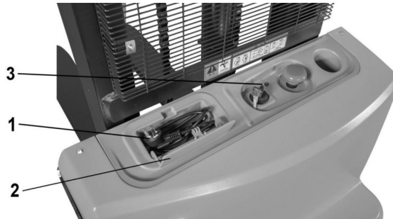
[그림 13] 충전 플러그(1), 거치대 커버(2), 충전 표시등(3)
